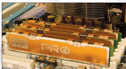
Pamäte DDR3 GoodRAM PRO sa stali súčasťou našej testovacej zostavy; procesory aj grafické karty zásadne testujeme v kombinácii s najrýchlejšími komponentmi, aby sme zaručili perfektne škálované výsledky
